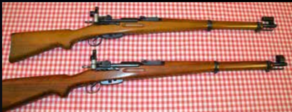
Due moschetti con diopter, sopra con l'iris e il portamirino tipo «S», sotto con il disco forato e il portamirino tipo «K».
