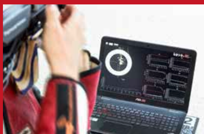
Il monitor mostra a sinistra i movimenti del sistema Scatta e a destra le forze dei sensori SCHUNK. I primi studi hanno indicato tra l'altro importanti fatti sulle forze laterali e la dispersione.
