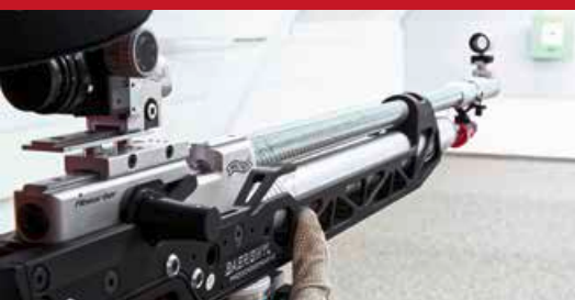
Anche sul punto di appoggio della mano un sensore misura i minimi movimenti.
