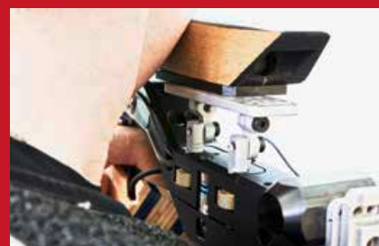
Il sensore nel facciale misura quali forze e momenti agiscono nel punto di contatto tra faccia e fucile. In certi atleti, a seguito delle misurazioni, si è modificato il modo di appoggiare la testa.
