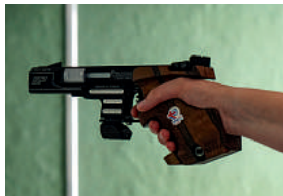
Bei der Sportpistole von Jessica Waeber wird der Sensor unter dem Magazin befestigt.
