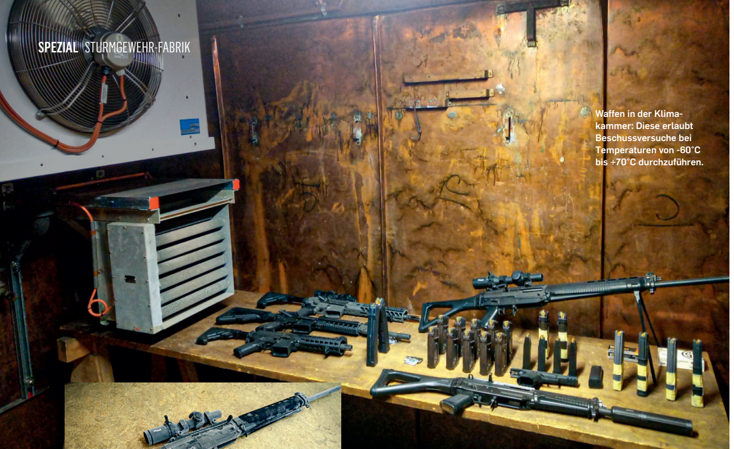
Das SG750 Creedmoor nach einem erfolgreichen Beschussversuch bei -54°C.
