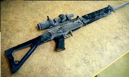
Das SG750 Creedmoor nach einem erfolgreichen Beschussversuch bei -54°C.
