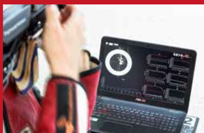
Der Monitor zeigt links den Zielverlauf des Scatt-Systems und rechts die Kraft- und Momenten-Werte der SCHUNK-Sensoren. Erste Studien brachten unter anderem wichtige Erkenntnisse hinsichtlich der Seitenkräfte, der Kippmomente und der Streuung.
