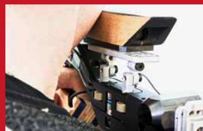
Der Sensor in der Backenauf- lage detektiert, welche Kräfte und Momente an der Kontaktfläche zwischen Kopf und Gewehr wirken. Bei einigen Athleten wurde aufgrund der Erkenntnisse bereits die Position der Auflage verändert.
