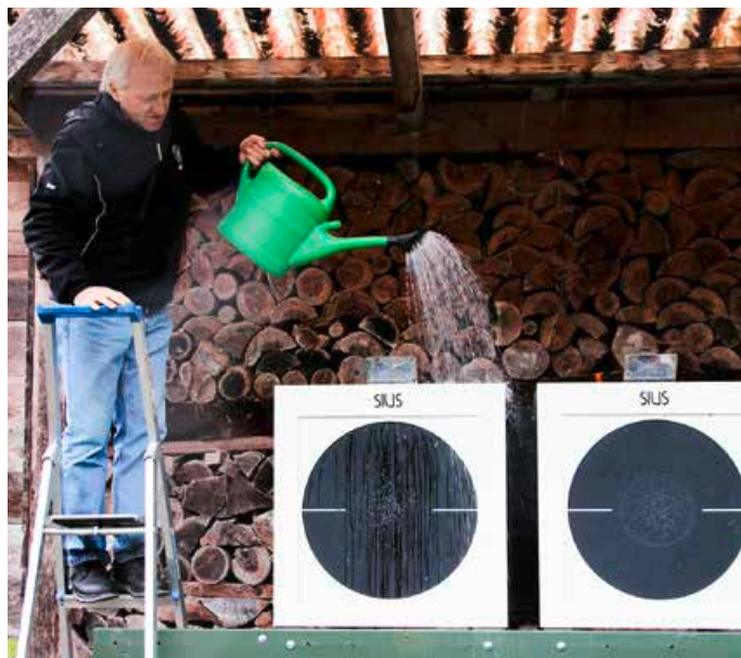
Willi Grill vom technischen Komitee der ISSF simuliert einen Starkregen. Der LS 25/50 schadete die kalte Dusche nicht. Sie funktionierte tadellos weiter.
