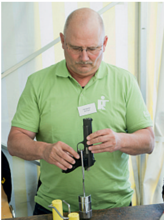
Genauigkeit ist bei der Sportgerätekontrolle Trumpf: Hanspeter Brühlhart prüft das Abzugsgewicht einer Pistole.
