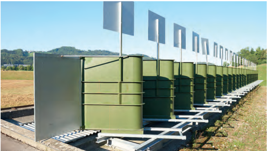
Abb. 49: Kugelfangsystem Seitenansicht MaRep
