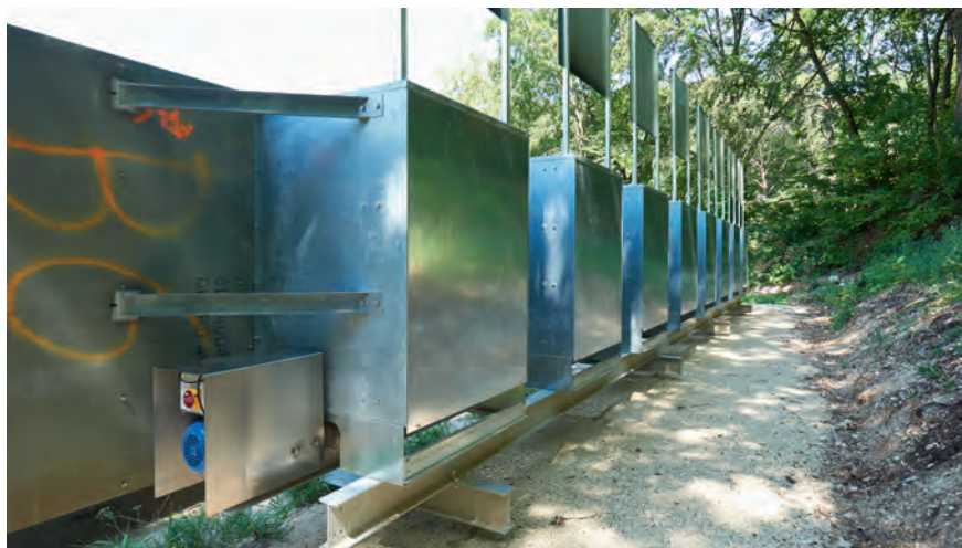
Abb. 53: Kugelfangsystem von hinten Berin mit Austragungssystem
