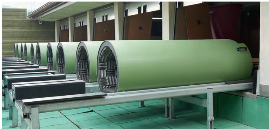
Fig. 22: Tunnel fonoassorbente (circolare)
