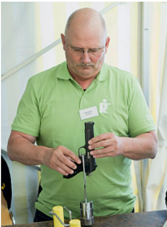
L'exactitude est reine lors du contrôle des armes de sport: Hanspeter Brühlhart vérifie le poids de détente d'un pistolet.
