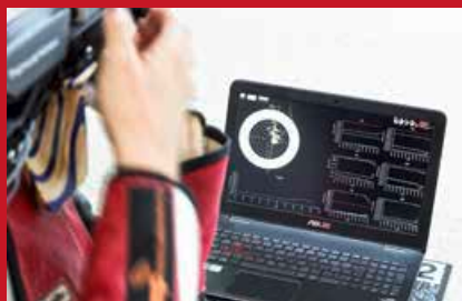
Le moniteur affiche la trajectoire cible du système Scatt à gauche et les valeurs de force et de moment des capteurs SCHUNK à droite. Les premières études ont notamment fourni des informations importantes sur les forces latérales, les moments de basculement et la diffusion.
