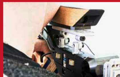
Le capteur dans l'appui-joue détecte les forces et les moments qui agissent sur la surface de contact entre la tête et la carabine. Chez certains athlètes, la position de l'appui-joue a déjà été modifiée en fonction des résultats.
