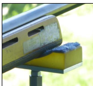
Il est interdit d'installer des cales-main pour la fixation
