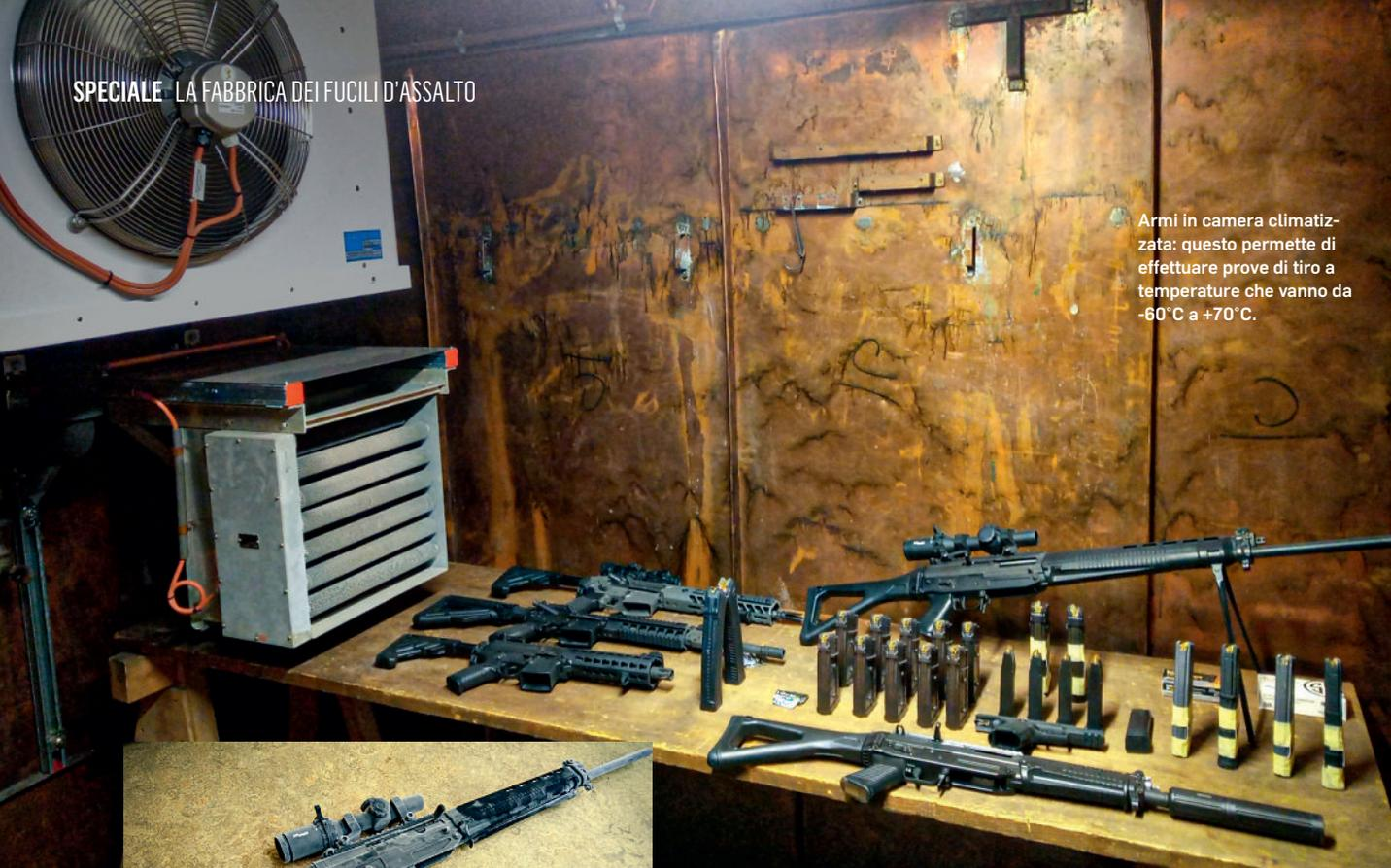
Armi in camera climatizzata: questo permette di effettuare prove di tiro a temperature che vanno da -60°C a +70°C.
