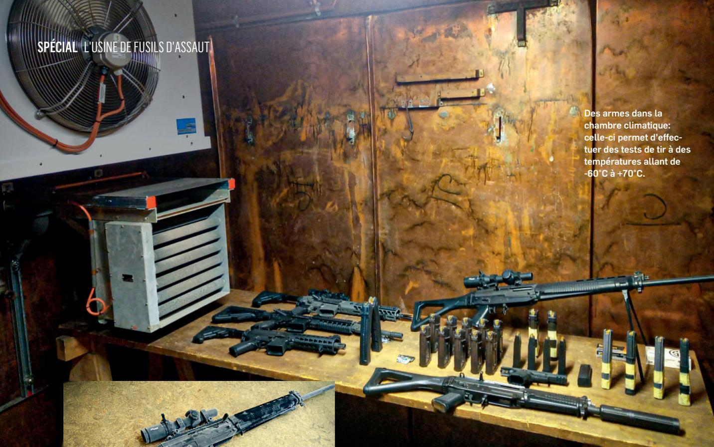
Des armes dans la chambre climatique: celle-ci permet d'effectuer des tests de tir à des températures allant de -60°C à +70°C.
