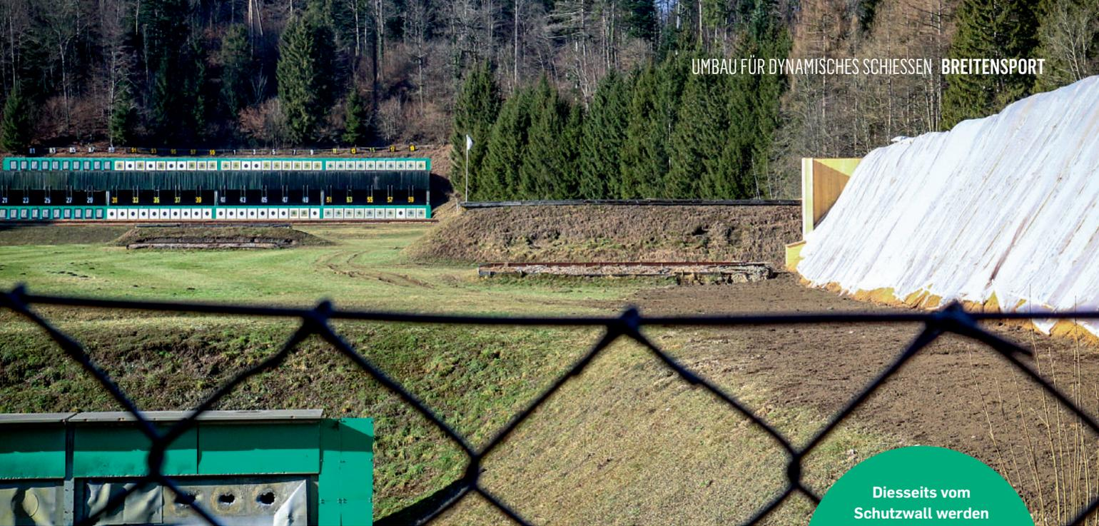
Diesseits vom Schutzwall werden auch noch in den bestehenden 100m- und 200m-Ständen neue demontierbare Kugelfangsysteme eingebaut.
