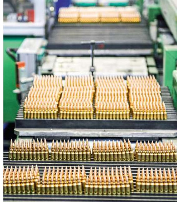
Différents types de projectile sont produits à Thoune - des projectiles à enveloppe pleine aux projectiles à noyau mou en passant par ceux à pointe creuse.
