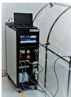
Das Innere eines Begasungszelts. Jedes der Zelte, in denen Objekte behandelt werden wird einzeln überwacht. Das geschieht über Kontrolltürme wie diesen hier.
