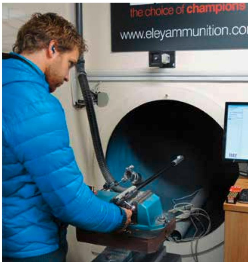
Le canon d'un système est fermement maintenu afin que les gerbes de touchés puissent être comparées.
