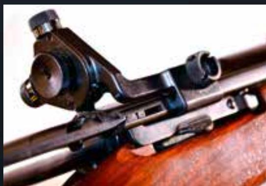
Le dioptre a été fixé à l'aide d'une vis sur le boîtier de culasse.
