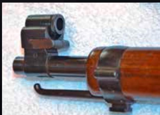
mettre le pousse-guidon sur le porte-guidon, puis faites glisser le guidon vers l'avant ou l'arrière selon son envie. Une grande partie des mousquetons était encore équipée de cette manière jusque dans les années 60. Bien entendu, des personnes débrouillardes avaient déjà développé une correction latérale construite sur un viseur latéralement mobile. Mais cette deuxième vis de réglage sur le viseur devait d'abord être approuvée et être incluse dans le catalogue des moyens auxiliaires.
